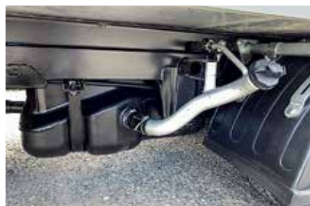
Горловина 80-литрового бака закрывается на замок – полезное для российских условий решение.
