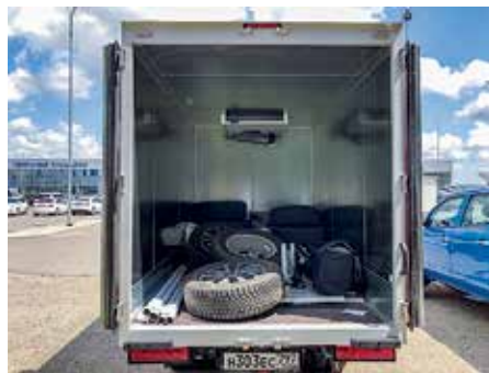
Один из вариантов надстроек – будка-рефрижератор. Внутренние габариты не детские: 3045×1675×1810 мм.
