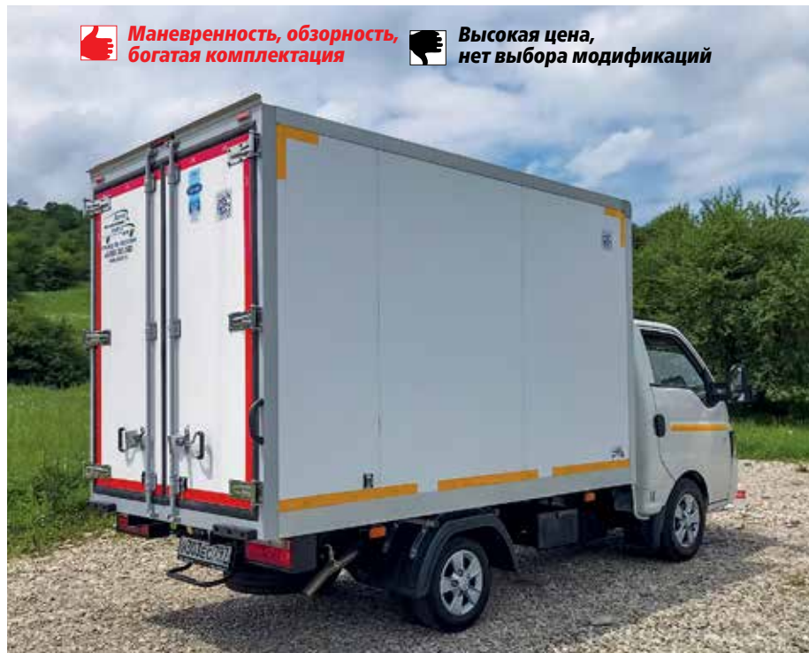
Один из вариантов надстроек – будка-рефрижератор. Внутренние габариты не детские: 3045×1675×1810 мм.
