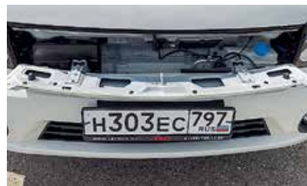
За фальшрадиаторной решеткой располагаются горловина для стеклоомывайки и воздушный фильтр.
