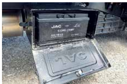
Аккумулятор располагается в запираемом металлическом коробе по правому борту машины. Слева – такой же по форме инструментальный ящик.
