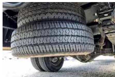
Пирамидка: снизу – переднее запасное колесо, сверху – компактное заднее.
