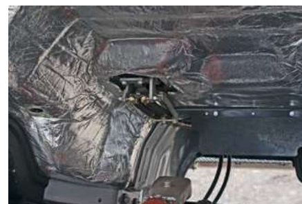
Под кабиной проложены тросы управления коробкой передач
