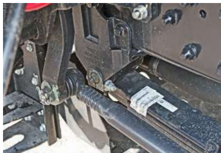
Пальцы и втулки передних рессор надо периодически смазывать
