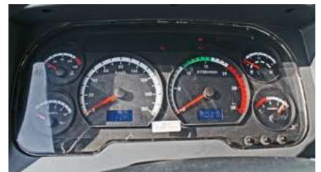
Комбинация приборов – сплошные стрелки. Зато просто и надежно
