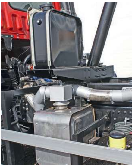
Мотор в исполнении Евро-5, поэтому глушитель сделан из нержавеющей стали
