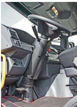
У рулевой колонки регулировка по высоте расположения руля и по углу наклона
