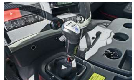
Диапазоны демультипликатора переключает пневмоклавиша на рычаге
