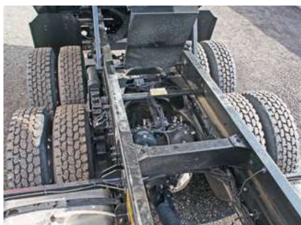
Похоже рама на JAC N350 6x4 самая высокая и толстая в КНР
