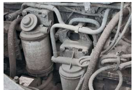
Раньше топливные фильтры стояли на двигателе и выглядели вот так
