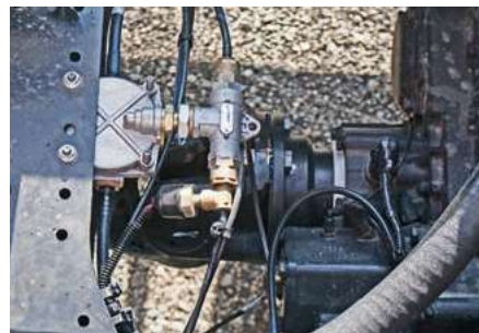
На JAC N350 используется лицензионная пневмоаппаратура Wabco
