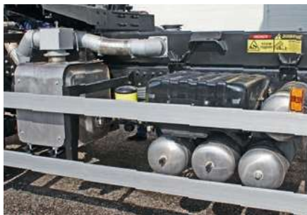
В пневмосистеме применены четыре алюминиевых ресивера
