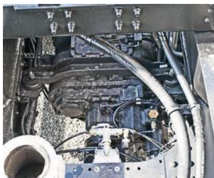
Задняя часть коробки подвешена на дополнительной траверсе
