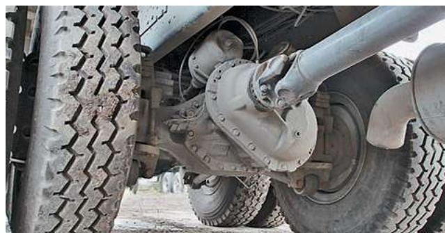
Ведущие мосты – Benz Technology, то есть сделаны по германской лицензии. Такие же мосты стоят на Beifang-Benchi
