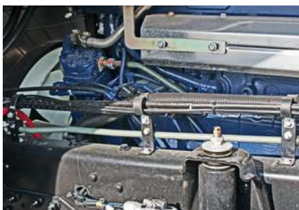
10-литровый дизель глубоко спрятан в высоких лонжеронах рамы
