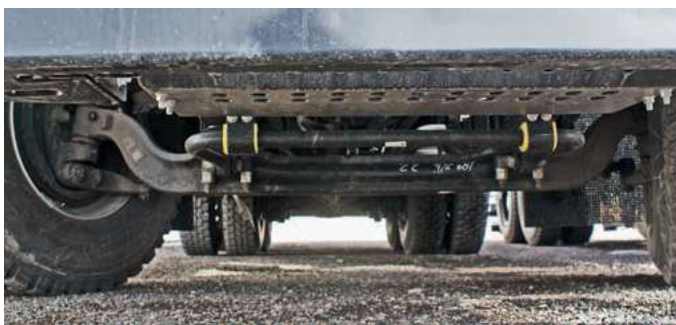
Стабилизаторы поперечной устойчивости установлены на передней оси, а также на втором ведущем мосту
