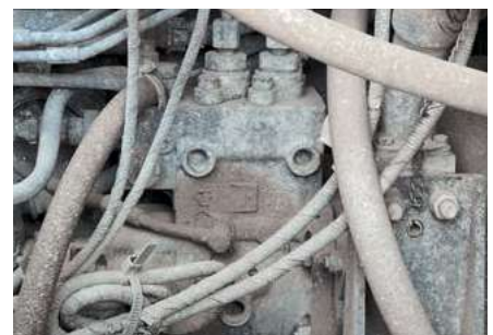
Это топливный насос высокого давления системы Common Rail
