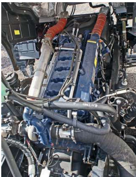
У четырехклапанных головок широкие клапанные крышки
