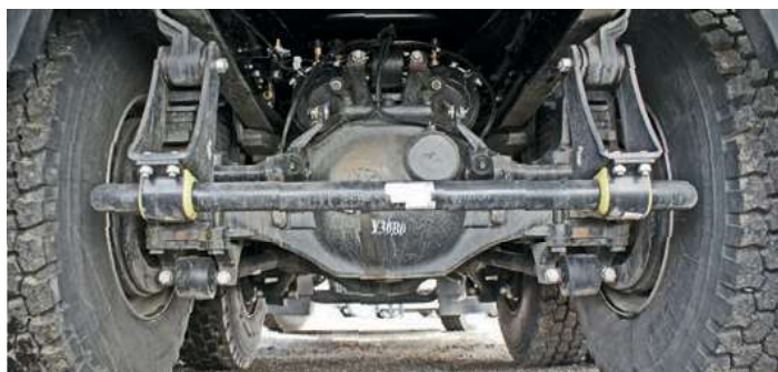
Литые стальные балки ведущих мостов выдерживают нагрузку в 16 тонн, но в характеристиках написано – по 13 810 кг каждая
