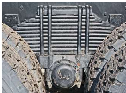
Четыре стремянки на каждом баланси- ре – гениальное решение!
