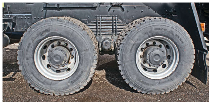
На китайских самосвалах других мостов, кроме как со ступичными планетарными редукторами и не бывает
