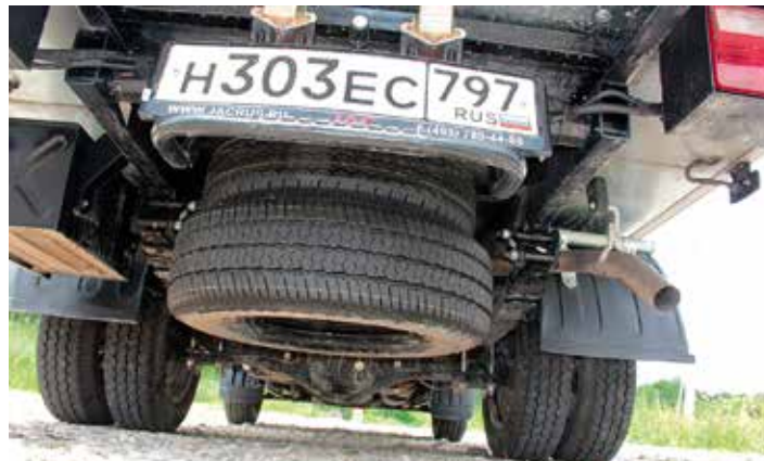
Разные шины на осях предполагают иметь на борту две запаски
