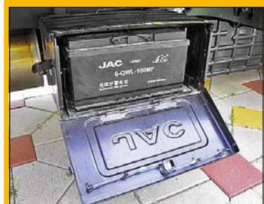
**СПОРНО.** Аккумуляторная батарея упрятана в ящик, который лишен запорного устройства.
