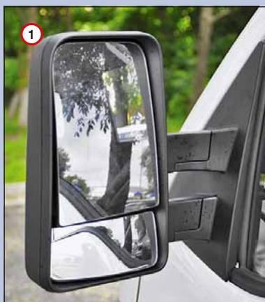
**1.** Зеркала с электроприводом и обогревом. Нижняя секция, полусфера, не регулируется.
