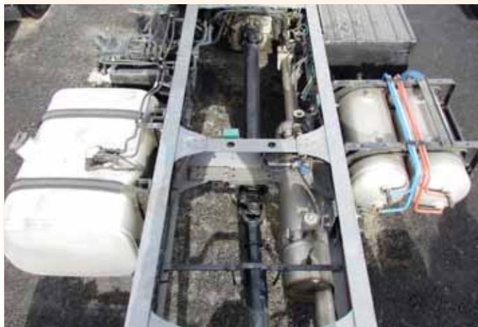
Новые партии JAC N75 приходят с выполненными из нержавеющей стали топливным баком увеличенного объема и ресиверами
