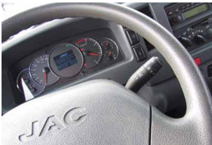
Приборная панель информативна и снабжена дисплеем, сообщаящим водителю информацию о состоянии и неисправностях узлов и агрегатов
