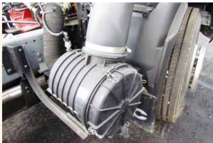
Воздушный фильтр повернут горизонтально и дополнительно герметизирован с целью гарантированно избежать просачивания влаги
