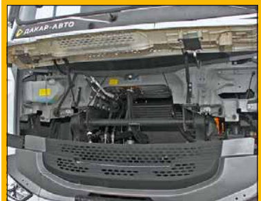
СПОРНО. Горловина бачка омывателя расположена высоко.
