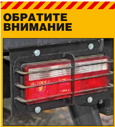
НАДЕЖНО. Задние фонари снабжены металлической защитой.
