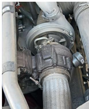
**Турбокомпрессор несет именитую марку Holset на самой отливке корпуса**
