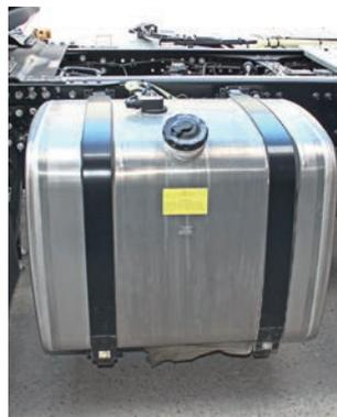
**Дополнительный бак емкостью 400 л установлен на раме тягача справа**
