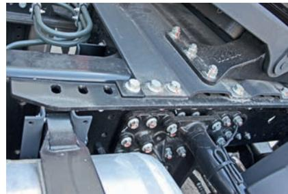
**Ряды отверстий в лонжеронах позволяют регулировать положение сидла**
