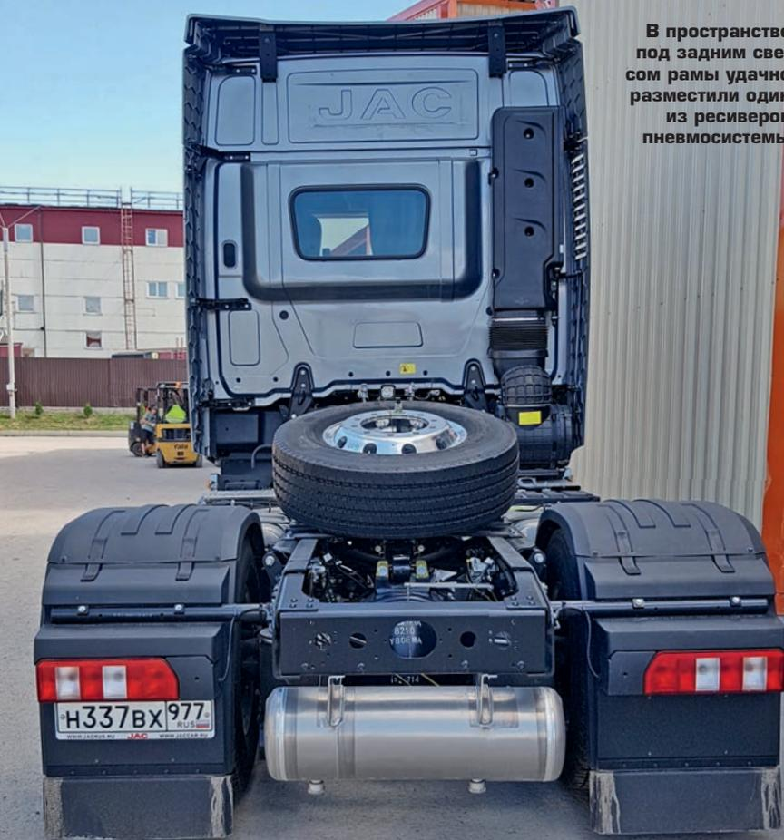
В пространстве под задним свесом рамы удачно разместили один из ресиверов пневмосистемы
