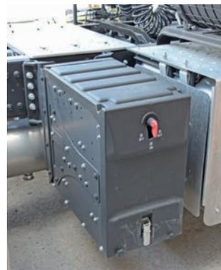
**На внешней стороне аккумуляторного отсека есть флажок выключателя «массы»**
