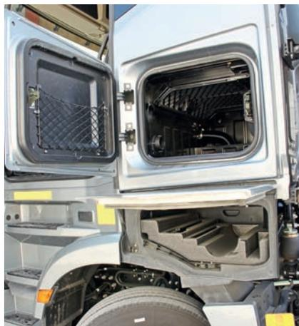
**Снаружи кабины предусмотрены отсеки для инструмента**
